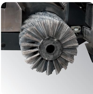
oraria. Permette la raccolta di detriti solidi. Gruppo spazzola in acciaio inox. Innovativo sistema AIR RECOVERY (brevettato), grazie ad aria compressa canalizzata davanti alla spazzola si evita la dispersione laterale
