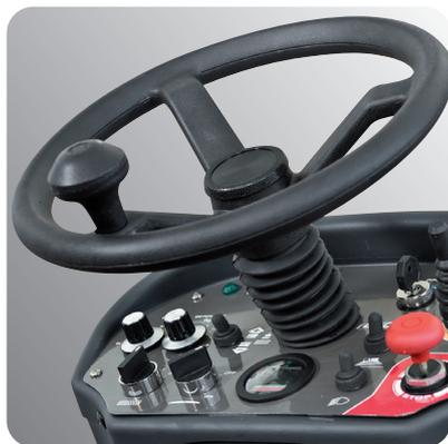
Pannello di controllo con comandi facile e intuitivo dotato di: contaore, indicatore del livello di carica della batteria, spia del serbatoio vuoto e indicatore di trazione in avanti/indietro. Regolazione della
